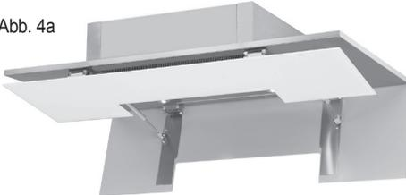
Danach Griffleiste der Aktivkohle-Fettfilter-Kombi leicht zur Haubenmitte drücken, Aktivkohle-Fettfilter-Kombi herausklappen und schräg nach unten herausnehmen (Abb. 4b):
