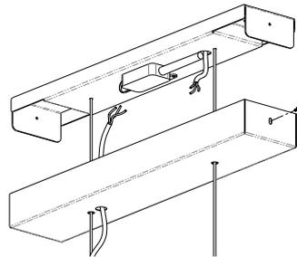
Haubenseitiges Netzanschlusskabel (ca. 200 cm) kann an allen 4 Seilen hochgeführt werden.
